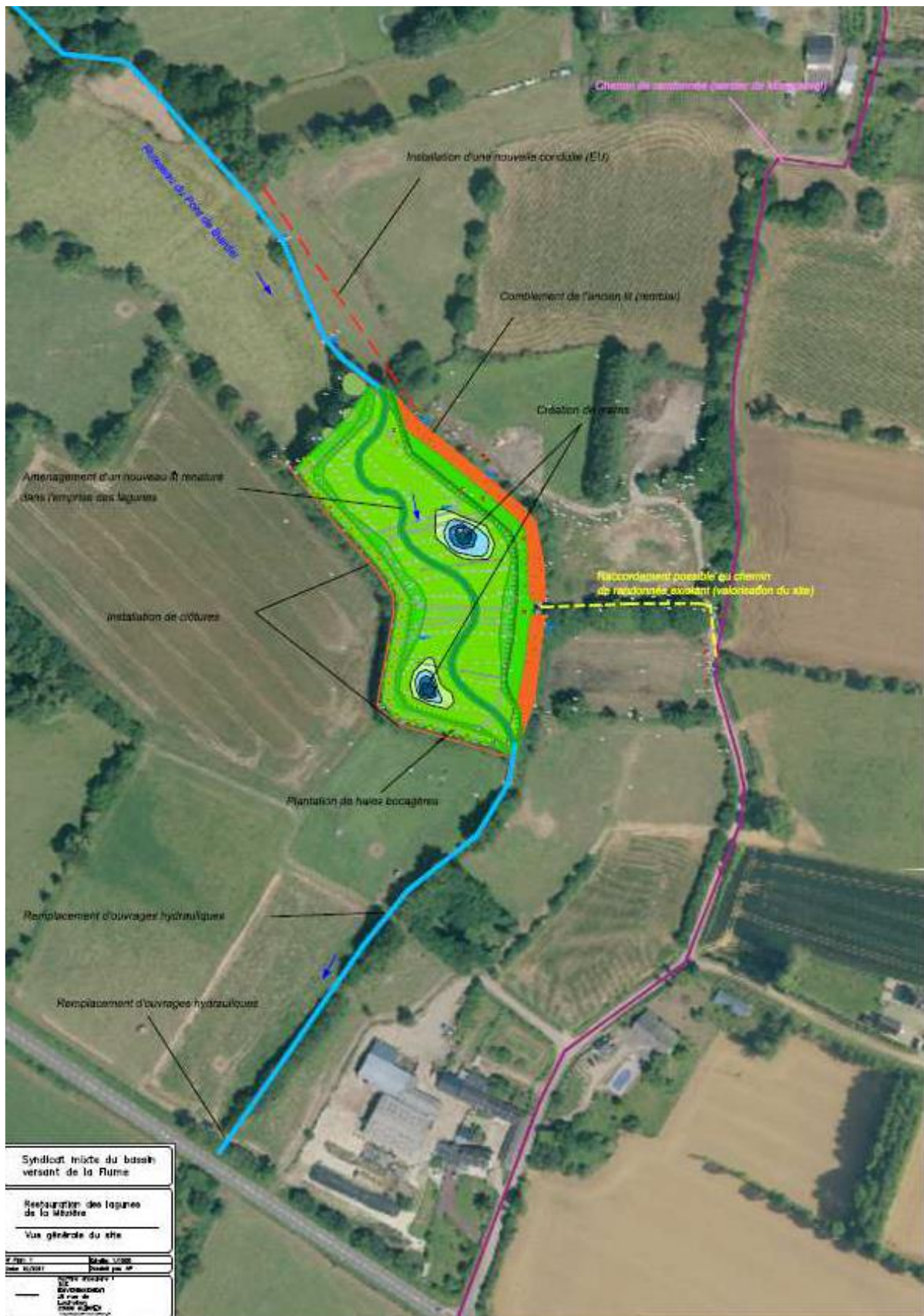
Plan masse des travaux de réhabilitation des anciennes lagunes d'assainissement de LA MEZIERE et du ruisseau attenant du Pont Biardel.
